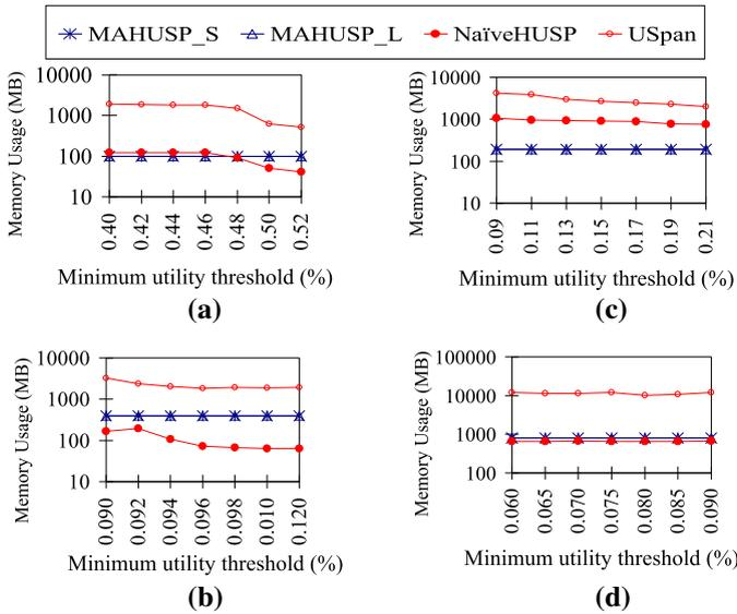
**Fig. 11** Memory usage of the algorithms (shown in logarithmic scale). **a** DS1, **b** DS2, **c** Kosarak, **d** ChainStore
